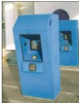
*Autoschalter mit Video, Rohrpost und Sprechanlage*
